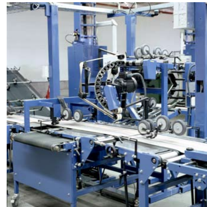
▲ Die Post Press Konfiguration enthält eine einzigartige Lösung für die Verarbeitung der 2x8 Seiten Produktion, die mit dem geschlossenen Kopf voran ausgelegt wird. Über eine in-line Ecke wird diese Produktion um 90° umgelenkt und über den 180°-Hochförderer sowie den Spiral-Förderer mit dem Rücken voran wieder in den geraden Produktfluß eingegliedert, damit der Kopf- und Fußbeschnitt möglich wird.
