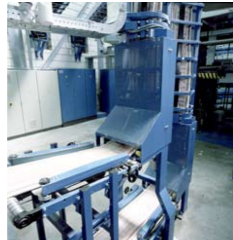
▲ Vier Hochförderstrecken übernehmen die Schuppenströme von fünf Falzauslagen und transportieren sie in den Weiterverarbeitungssaal.
