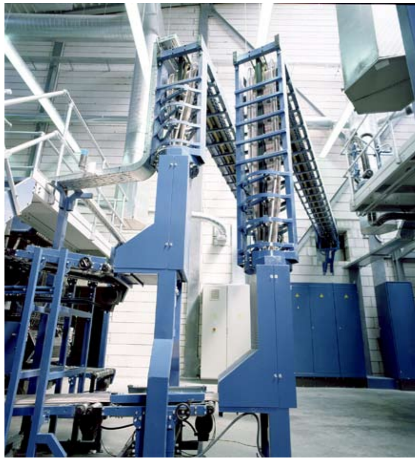
▲ Vier Hochförderstrecken übernehmen die Schuppenströme von fünf Falzauslagen und transportieren sie in den Weiterverarbeitungssaal.
