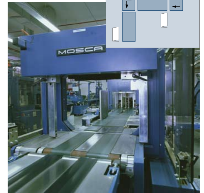
▲ Die Linien 1 und 2 werden vor der Umreifungsmaschine zusammengeführt. Während die Pakete der einen Linie geradeaus durchlaufen, werden die Pakete der anderen Linie über eine Ecke und einen Distributor in den geraden Produktionsfluß eingegliedert.
