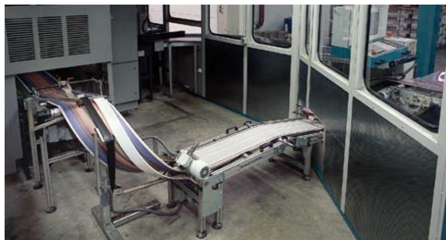
▲ Gesamtansicht der Post Press Anlage: Förderbandlinie mit Makulaturausschleusung, RS 830 Schneidelinie mit durchfahrbarer Ecke, RS 31SL High-Speed Kreuzleger mit direkt angeschlossener Umreifungsmaschine. Ungeschnittenen Produktionen durchfahren die Ecke zwischen den Schneidern und der Schuppenstrom gelangt ohne weitere Umlenkung in den Kreuzleger.
