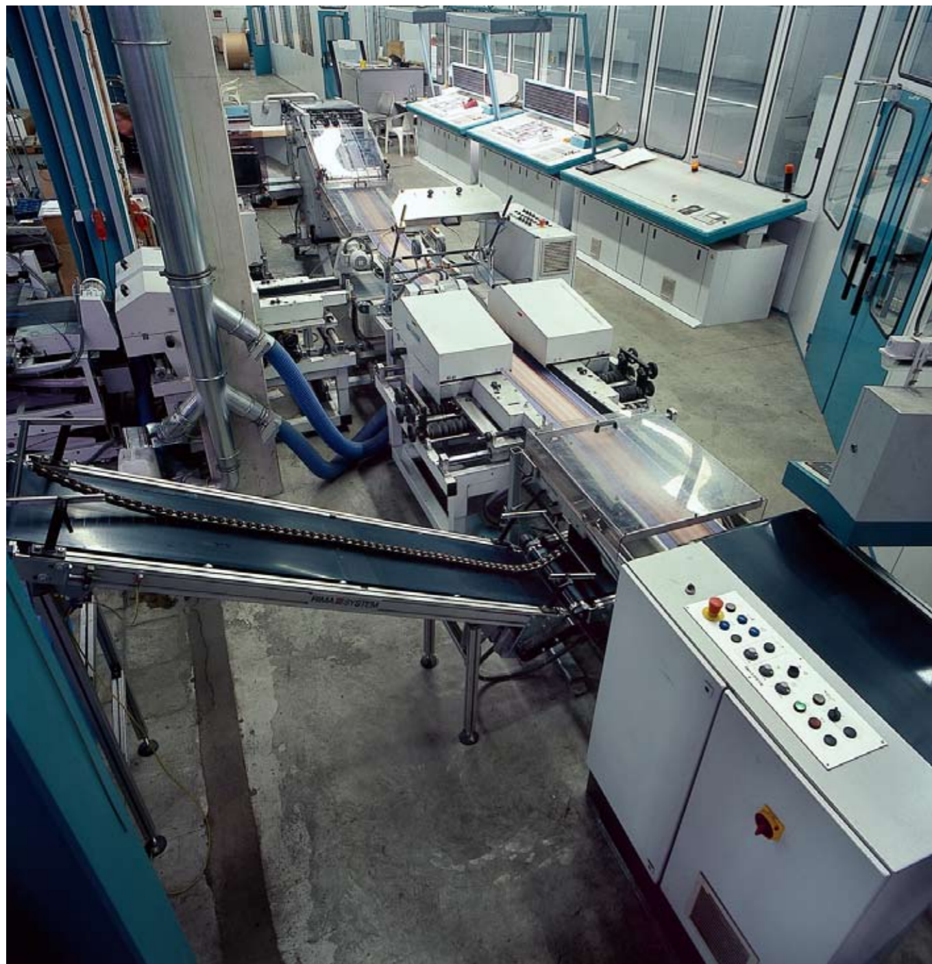
▲ Gesamtansicht der Post Press Anlage: Förderbandlinie mit Makulaturausschleusung, RS 830 Schneidelinie mit durchfahrbarer Ecke, RS 31SL High-Speed Kreuzleger mit direkt angeschlossener Umreifungsmaschine. Ungeschnittenen Produktionen durchfahren die Ecke zwischen den Schneidern und der Schuppenstrom gelangt ohne weitere Umlenkung in den Kreuzleger.
