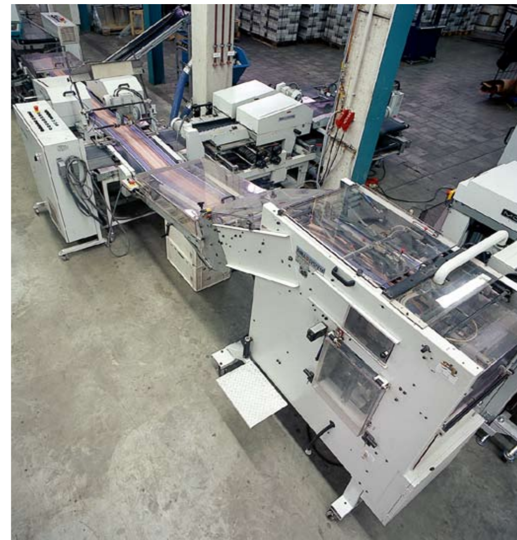
◀ Durch einfaches Verfahren übernimmt der RS 31SL High-Speed Kreuzleger entweder den beschnittenen Schuppenstrom hinter der Schneidelinie oder die unbeschnittenen Produkte direkt hinter der durchfahrbaren Ecke. Ausgestattet mit einem Servopusher verarbeitet der RS 31SL bis zu 120.000 Ex/h zu sauber ausgerichteten Paketen.
