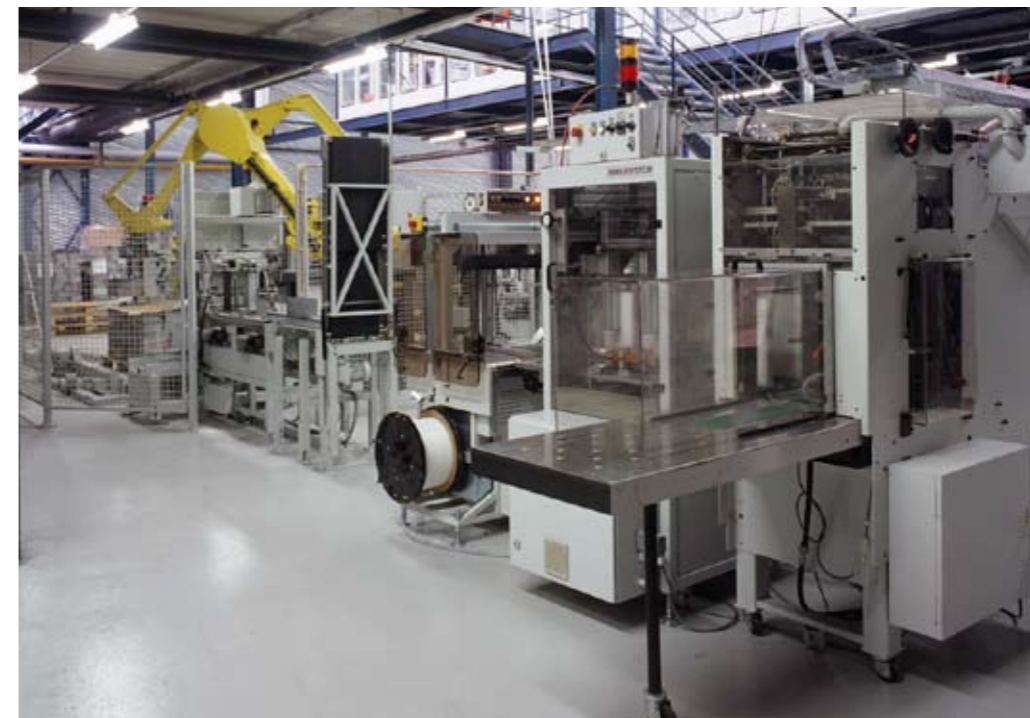
▲ Die direkte Kopplung zwischen Kreuzleger und Verblocker erlaubt auch die Verarbeitung schwieriger Produkte (geringe Grammaturen mit hohem Farb- bzw. Silikonantrag und Rückenheftung), die ohne Verblockung kaum bzw. nur mit sehr hohem manuellen Aufwand zu verarbeiten sind.
