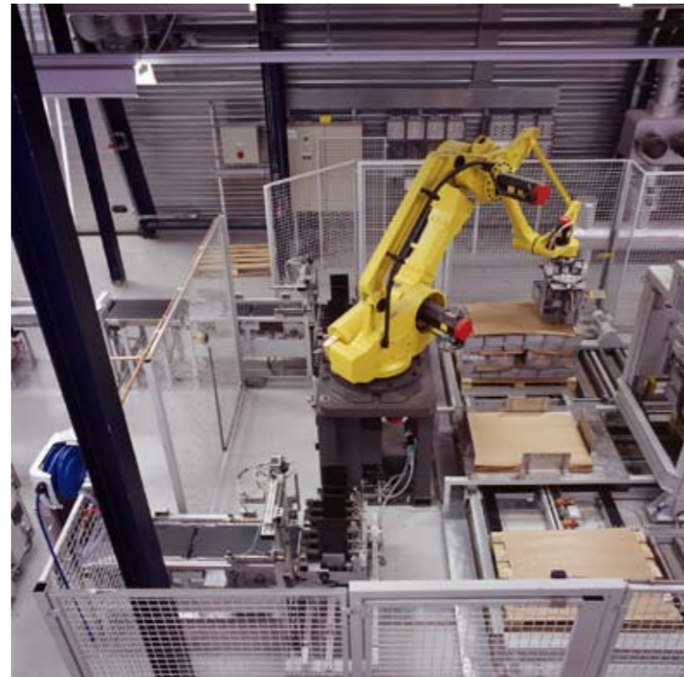
RS 400 High-Speed Palettierroboter mit Doppelgreifer. Der Roboter palettiert von 2 Linien auf 2 Paletten. Zwischenbogen können auf jede beliebige Lage platziert werden. Der Palettenspender fördert nach dem Ausstoß einer vollen Palette eine leere Palette auf den Palettierplatz.
