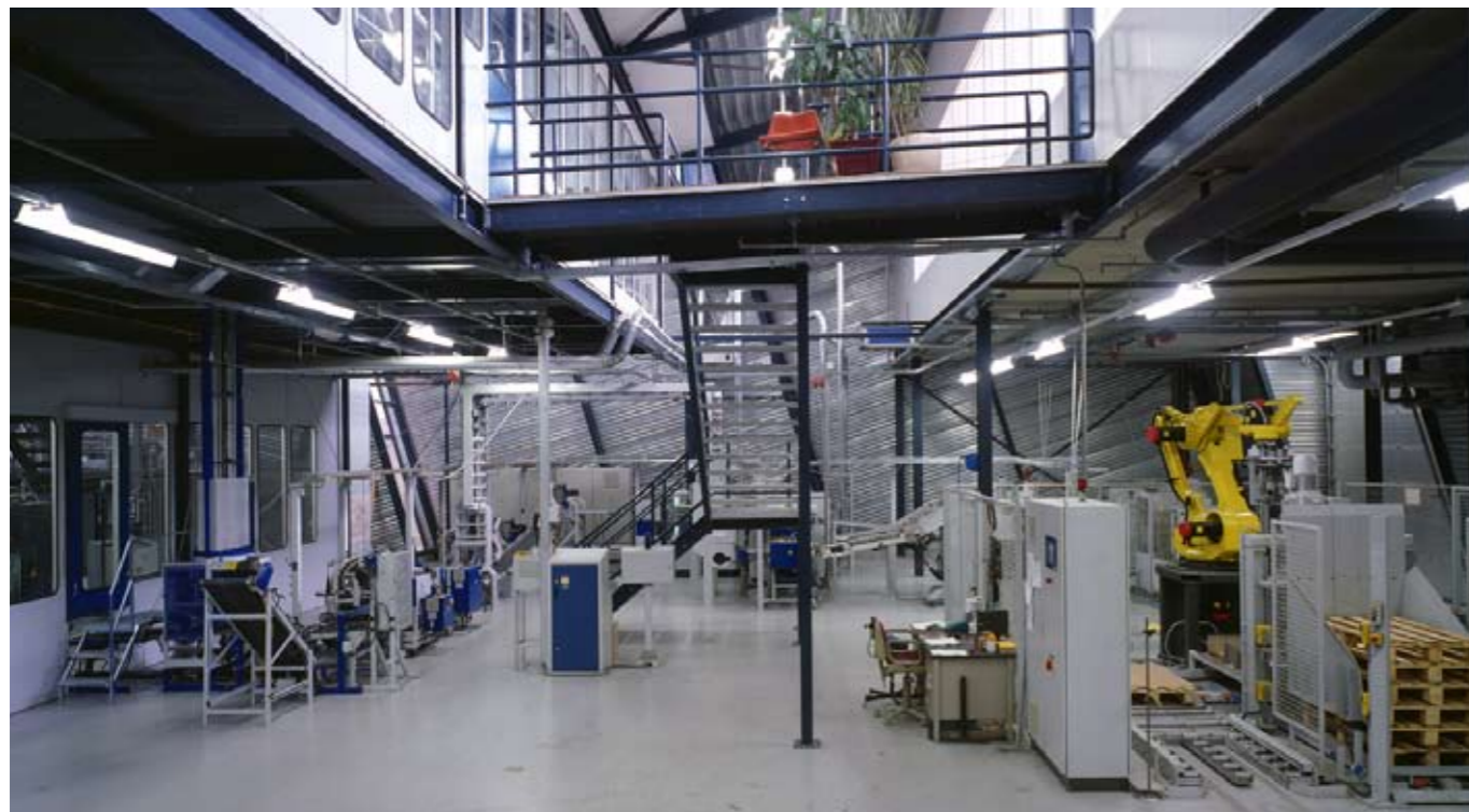
▼ Gesamtansicht der Post Press Lösung mit Boden- und Hochförderern, Doppelstromschneidern, Kreuzlegern, Verblockern, Umreifung und Palettierroboter.
