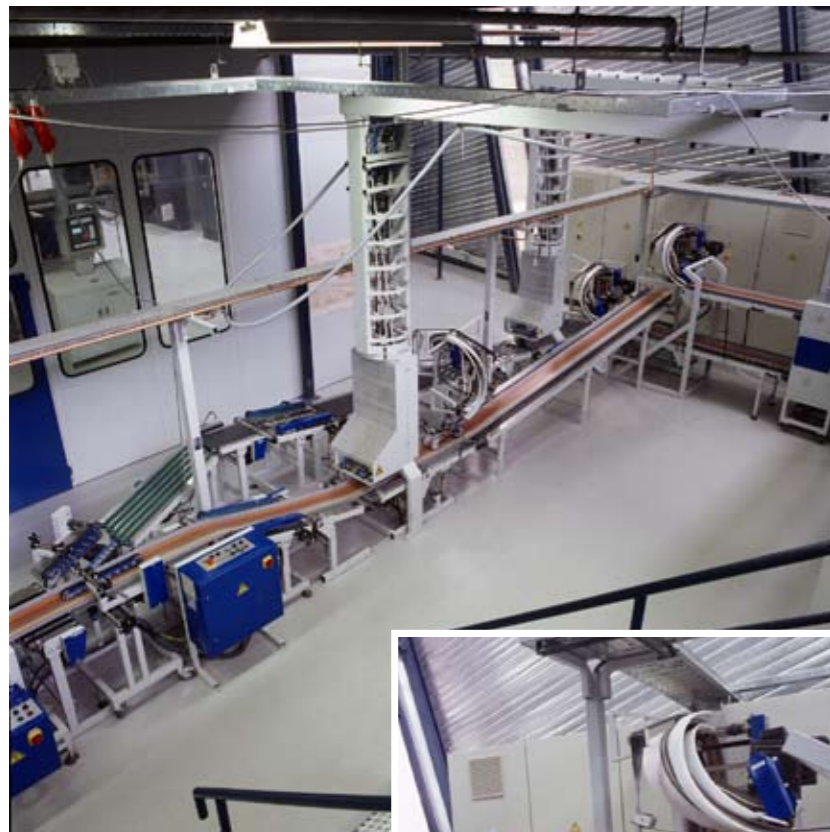
▲ Ansicht der verschiedenen Förderstrecken: Die Hochförderer transportieren die ungeschnittene Brutto-Produktion direkt zu den Kreuzlegern. Fertigprodukte durchlaufen die Schneidestraße. Bei einstromigen Produktionen bietet die Doppelspirale zwischen Linie 1 und 2 ein on-line Back-up.
