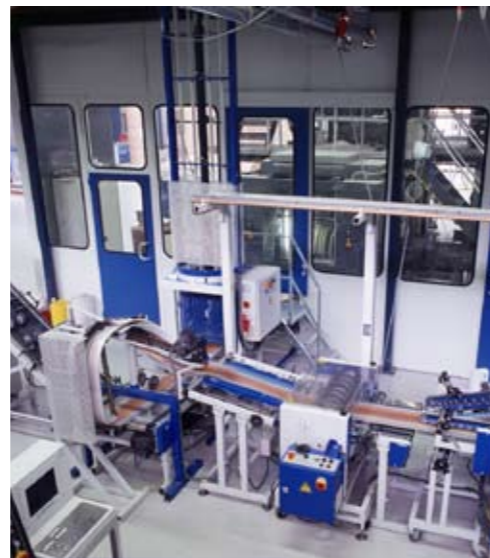
▲ Falzausgang mit Produktentnahmestation, 180°-Hochförderer sowie Spiralförderer, Abreßstation und Ausziehvorrichtung für die Produktion von 4x8 Seiten.
