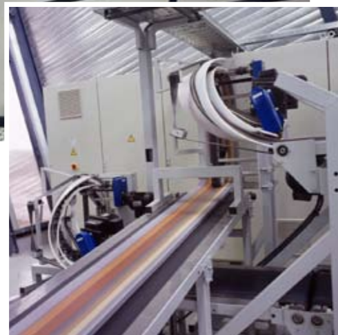
▲ Falzausgang mit Produktentnahmestation, 180°-Hochförderer sowie Spiralförderer, Abreßstation und Ausziehvorrichtung für die Produktion von 4x8 Seiten.
