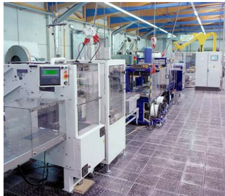
RS 31SL High Speed Kreuzleger mit Servo Pusher und direkt angeschlossenem Verblocker für perfekt ausgerichtete Pakete. Das nachfolgende Equipment erlaubt es, die Pakete vor dem Palettieren optional zu umreifen oder zu folieren.
