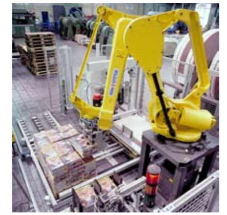
Doppelgreifer für High Speed Palettierung von losen, umreifen oder folierten Paketen. Bei maximaler Geschwindigkeit können bis zu 900 Pakete in der Stunde verarbeitet werden.
