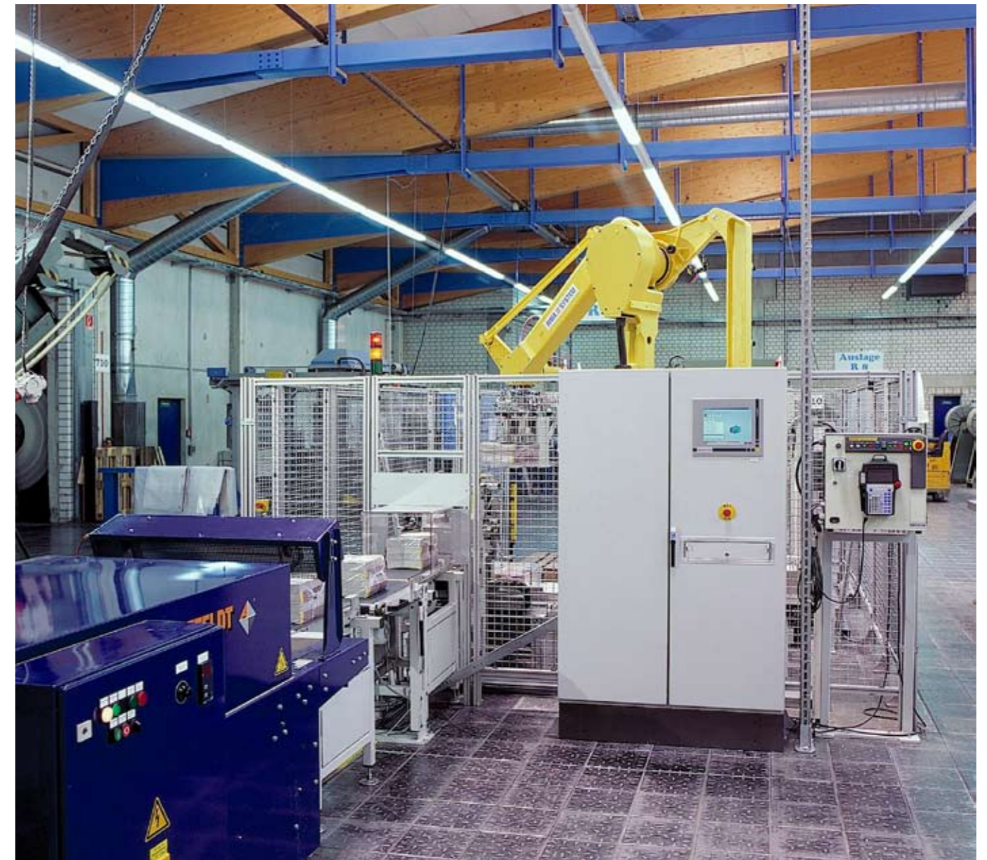
Folienumreifungsmaschine mit Schrumpftunnel, Stautaktförderband, Übergabestation und RS 400 High Speed Palettierroboter mit Palettenförderer, Leerpallettenmagazin und automatischem Zwischenbogenanleger.
