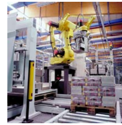
Doppelgreifer für High Speed Palettierung von losen, umreifen oder folierten Paketen. Bei maximaler Geschwindigkeit können bis zu 900 Pakete in der Stunde verarbeitet werden.
