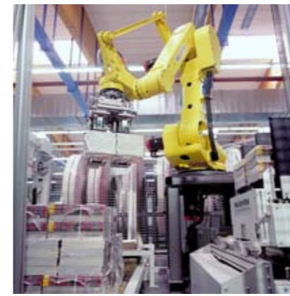
Doppelgreifer für High Speed Palettierung von losen, umreifen oder folierten Paketen. Bei maximaler Geschwindigkeit können bis zu 900 Pakete in der Stunde verarbeitet werden.
