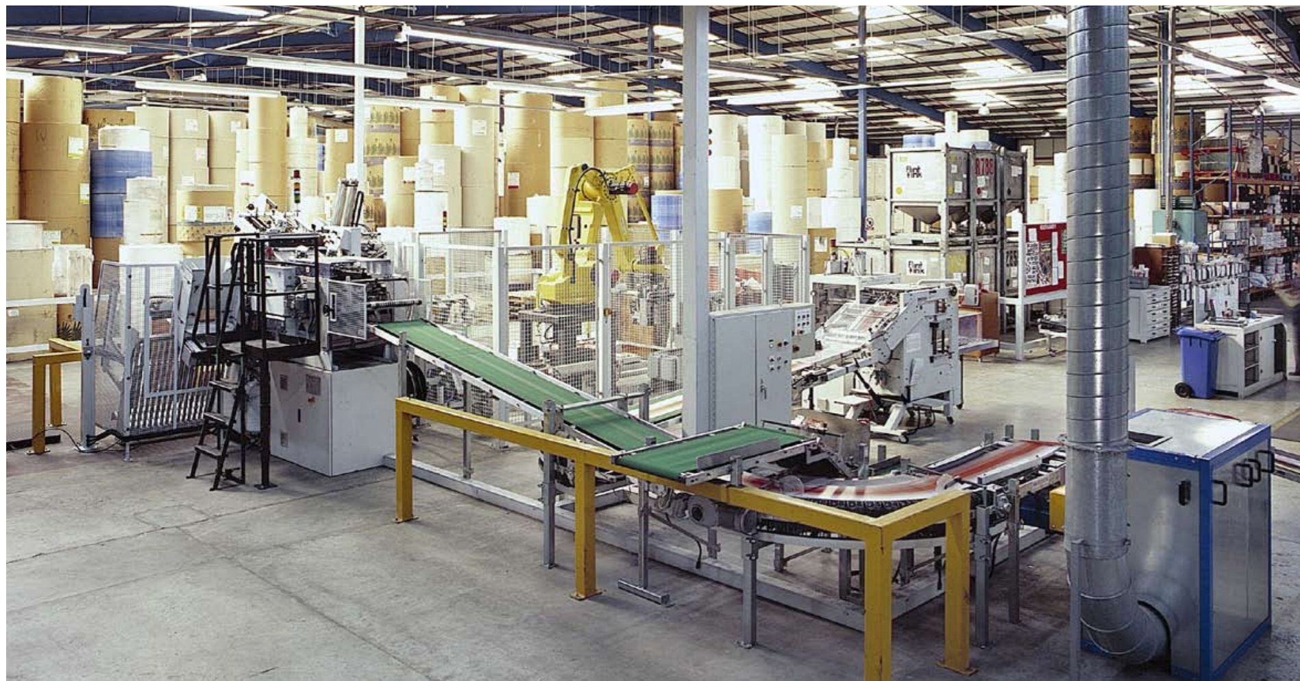
▲ Gesamtansicht der Post Press Lösung mit den ECO Förderbändern, dem vertikalen Stangenstapler, dem RS 31SL Kreuzleger, dem RS 100 Verblocker und dem RS 400 High Speed Palettierroboter.
