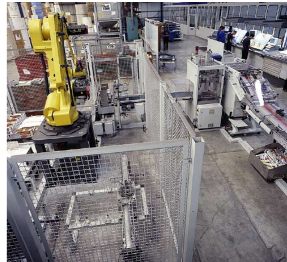
▲ Der RS 31SL Kreuzleger mit dem direkt angeschlossenen Verblocker sorgt für stabile Stapel. Die kreuzgelegten Pakete werden abgepreßt und mit einer elektrostatischen Ladung versehen, bevor die Stautaktbänder sie zur Übergabestation des Palettierroboters fördern.
