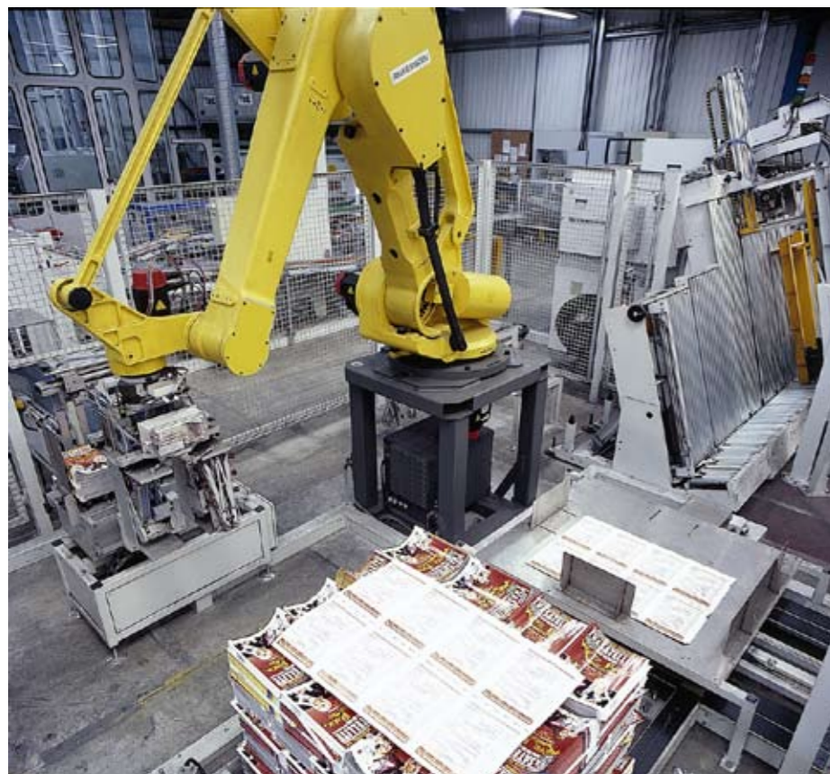
▲ Der RS 400 High Speed Palettierroboter palettiert lose Stapel oder abgepreßte Stangen. Zwischenbögen werden automatisch aufgelegt. Es kann eine maximale Palettiergeschwindigkeit von 800 Paketen/h bzw. 145 Stangen/h erreicht werden.
