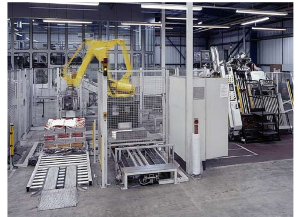
▲ Ansicht des RS 400 High Speed Palettierroboter für Stapel und Stangen mit Paletten-fördertechnik, Zwischenbogenanleger, Stangen- und Doppelgreifer. Abhängig von der jeweiligen Produktion, verwendet der Roboter entweder den Doppelgreifer für lose Stapel oder den Stangengreifer für Stangen mit einer Länge bis zu 1200 mm. Der Greiferwechsel ist vollautomatisch und in ca. 60 Sekunden vollzogen.
