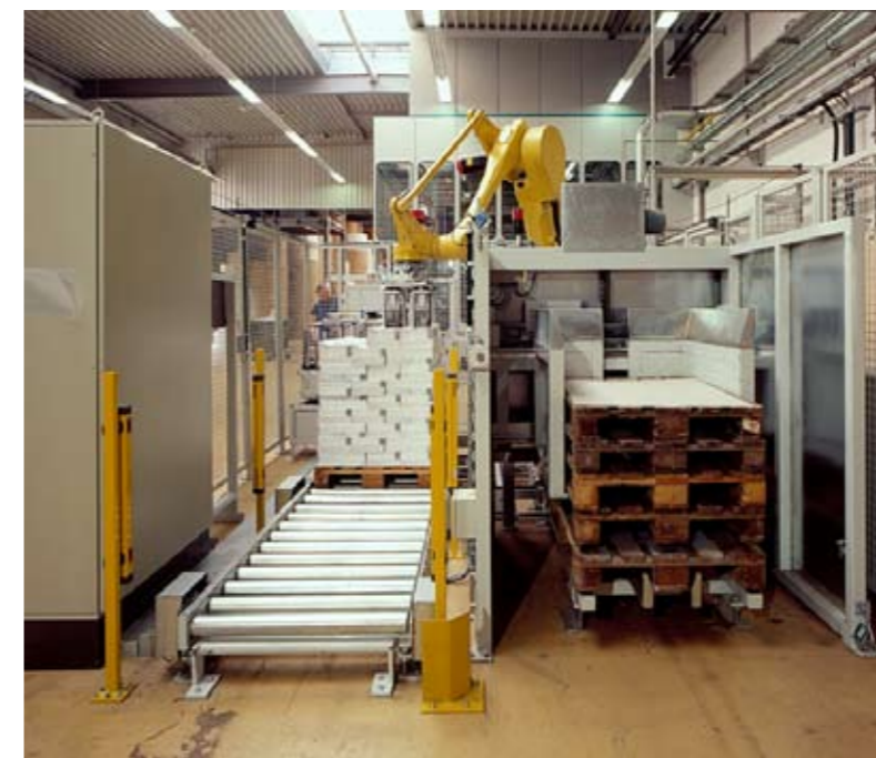
Über ein Stautaktband laufen die Pakete getaket in die Übergabestation des RS 400 Palettierroboters. Ausgestattet mit einem Doppelgreifer, Zwischenbogenanleger und Leerpalettenmagazin palettiert er bis 800 lose Pakete in der Stunde.
