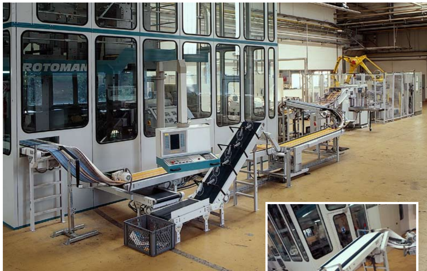
Automatisierte RIMA-SYSTEM Post Press Anlage für 1-Mann Bedienung: Über eine Förderbandlinie mit Spiralförderern, die eine sichere und platzsparende Führung des Schuppenstroms garantiert, gelangt der Schuppenstrom zum Schneide-, Kreuzlege- und Palettierbereich.
