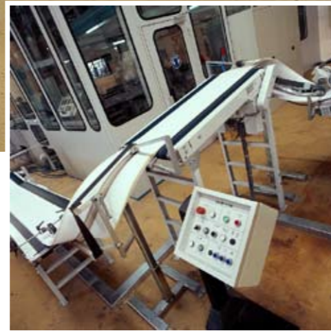
Ungeschnittene Produktionen durchfahren die Multiformat Ecke RS 220 mit Geradeausauslage und werden direkt zu dem RS 31SL Kreuzleger transportiert.
