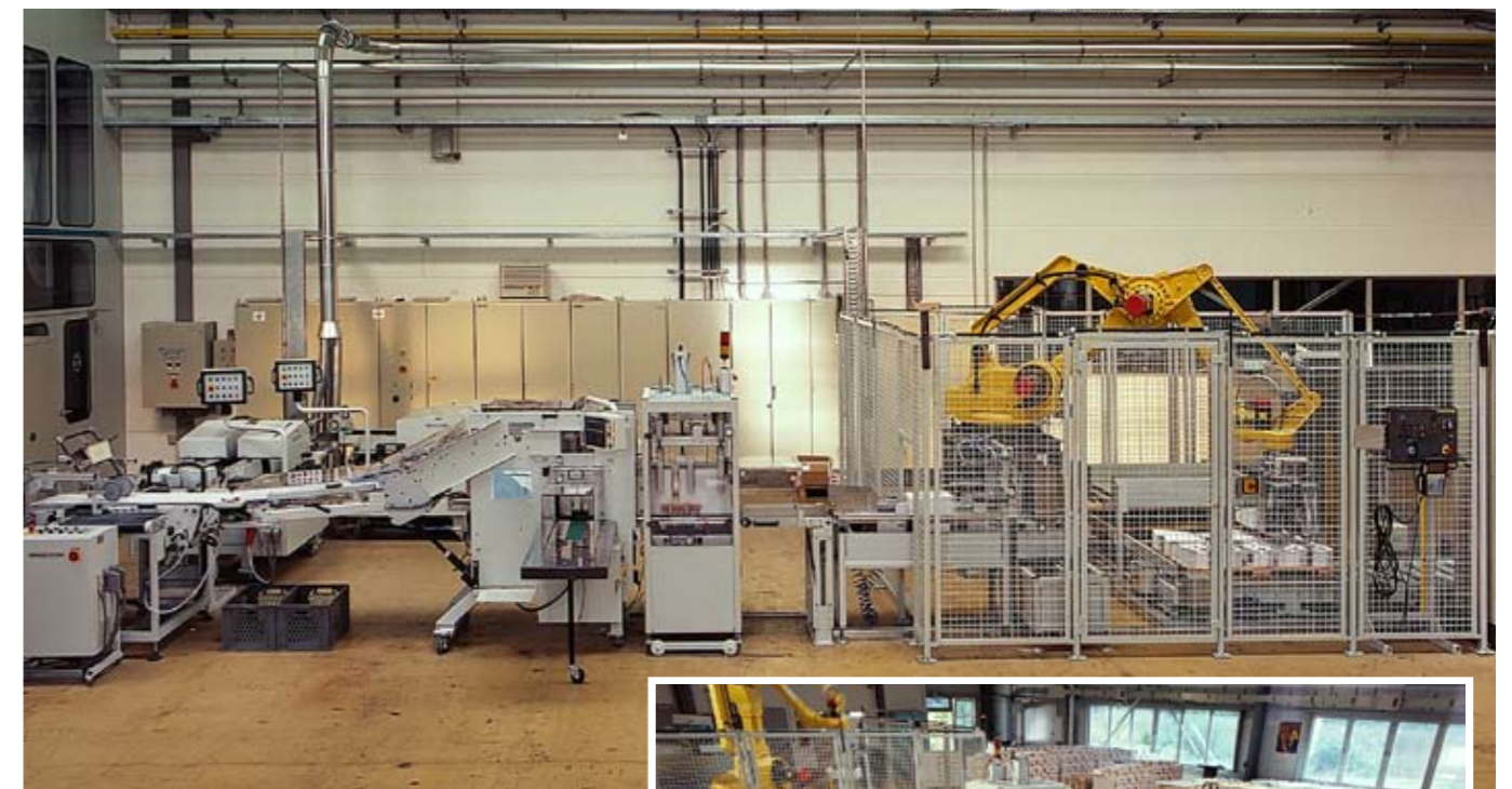
Alternativ werden geschnittene Produktionen in der Ecke um 90° umgelenkt und zur RS 830 Schneidelinie transportiert. Nach dem 3-Seiten Beschnitt werden die Produkte vom RS 31SL Kreuzleger gestapelt. Der direkt angeschlossene Verblocker stabilisiert die Pakete für die automatische Palettierung.
