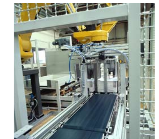
Über ein Stautaktband laufen die Pakete getaket in die Übergabestation des RS 400 Palettierroboters. Ausgestattet mit einem Doppelgreifer, Zwischenbogenanleger und Leerpalettenmagazin palettiert er bis 800 lose Pakete in der Stunde.
