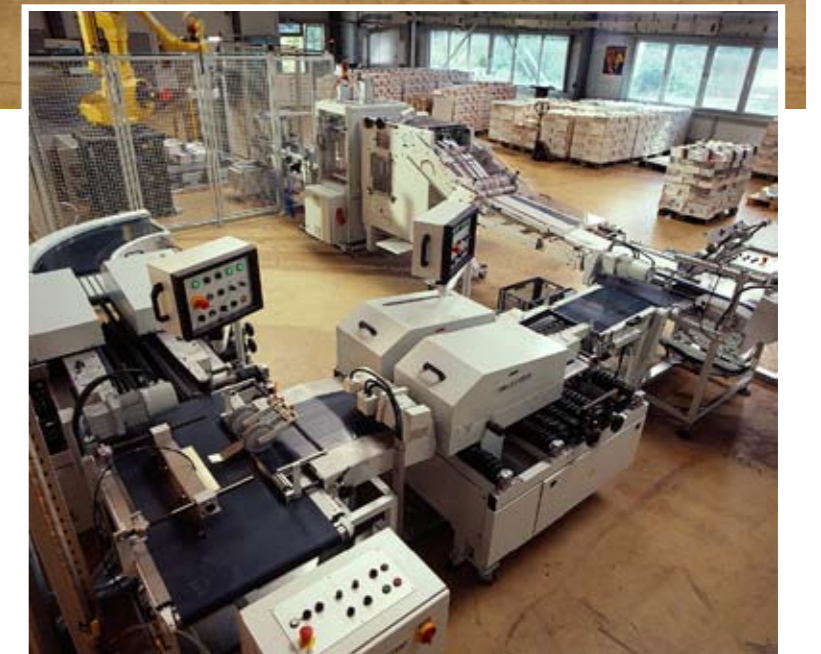
Alternativ werden geschnittene Produktionen in der Ecke um 90° umgelenkt und zur RS 830 Schneidelinie transportiert. Nach dem 3-Seiten Beschnitt werden die Produkte vom RS 31SL Kreuzleger gestapelt. Der direkt angeschlossene Verblocker stabilisiert die Pakete für die automatische Palettierung.
