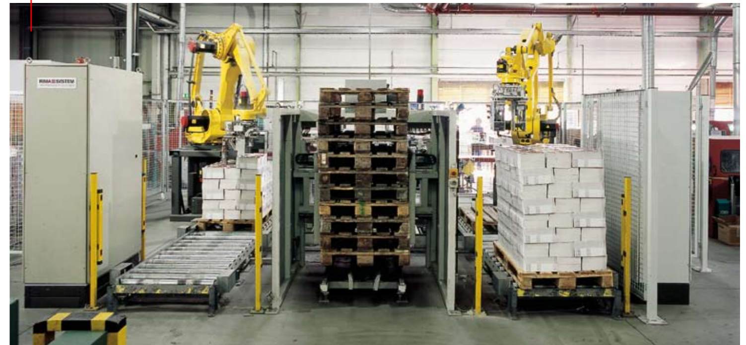
Das Leerpalettenmagazin der Palettierzelle fasst bis zu 15 Paletten und verteilt die Leerpaletten zu den beiden Palettierplätzen. Beide Roboterarme sind mit automatischen Zwischenbogenanlegern ausgestattet. Volle Paletten werden automatisch aus der Palettierzelle zur Abnahmestation transportiert.
