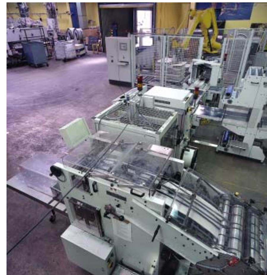
▲ Der RS 30S Kreuzleger ist direkt mit dem RS 100 Verblocker verbunden. Die Stapel werden im Verblocker durch automatisches Abpressen und elektrostatische Ladung stabilisiert, bevor sie über die Stautaktförderer zur Folienumreifung oder zur Übergabestation des Palettierroboters transportiert werden.
