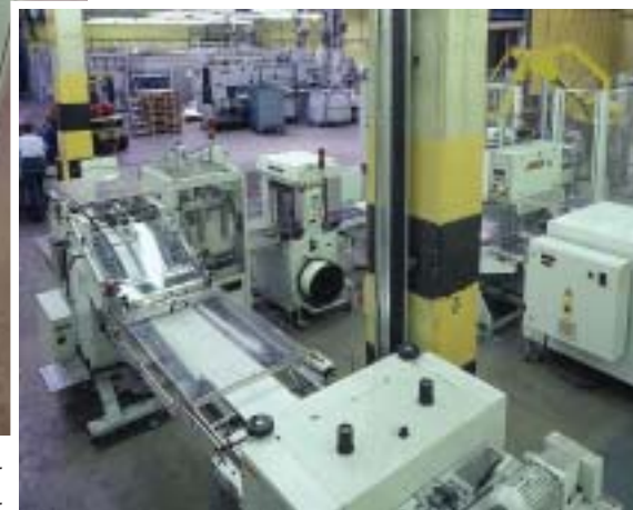
▲ High Speed Schneideline: Die RS 220 Multiformat Ecke mit Vakuumbändern transportiert und lenkt Produkte von 4 bis 128 Seiten bei einer Geschwindigkeit von über 100.000 Ex/h um.
