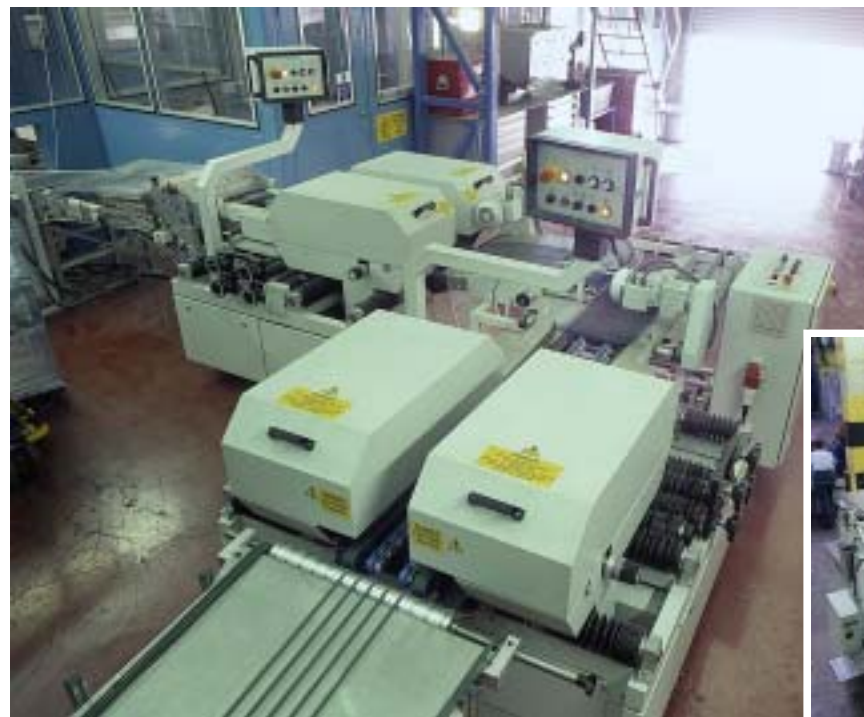
▲ High Speed Schneideline: Die RS 220 Multiformat Ecke mit Vakuumbändern transportiert und lenkt Produkte von 4 bis 128 Seiten bei einer Geschwindigkeit von über 100.000 Ex/h um.
