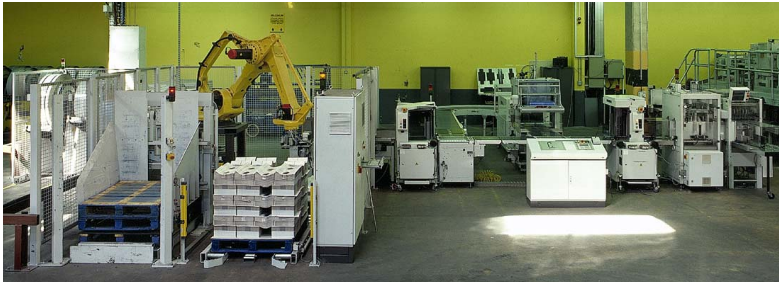
▲ Gesamtansicht der Post Press Lösung mit dem RS 30S Kreuzleger, dem RS 100 Verblocker, den Umreifungsmaschinen, den Stautaktfördersystemen und dem RS 400 High Speed Palettierroboter. Die Stapel können lose, umreift oder foliert zum Roboter transportiert werden. Die losen und umreift Stapel umlaufen die Folienmaschine.
