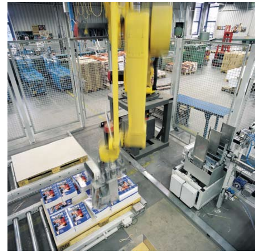
▲ Der RS 400 High-Speed Palettierroboter mit Doppelgreifer ermöglicht mit der „Smooth Approach Technology“ das sanfte und millimetergenaue Ablegen von über 900 Paketen/h von einer Linie auf zwei Paletten.
