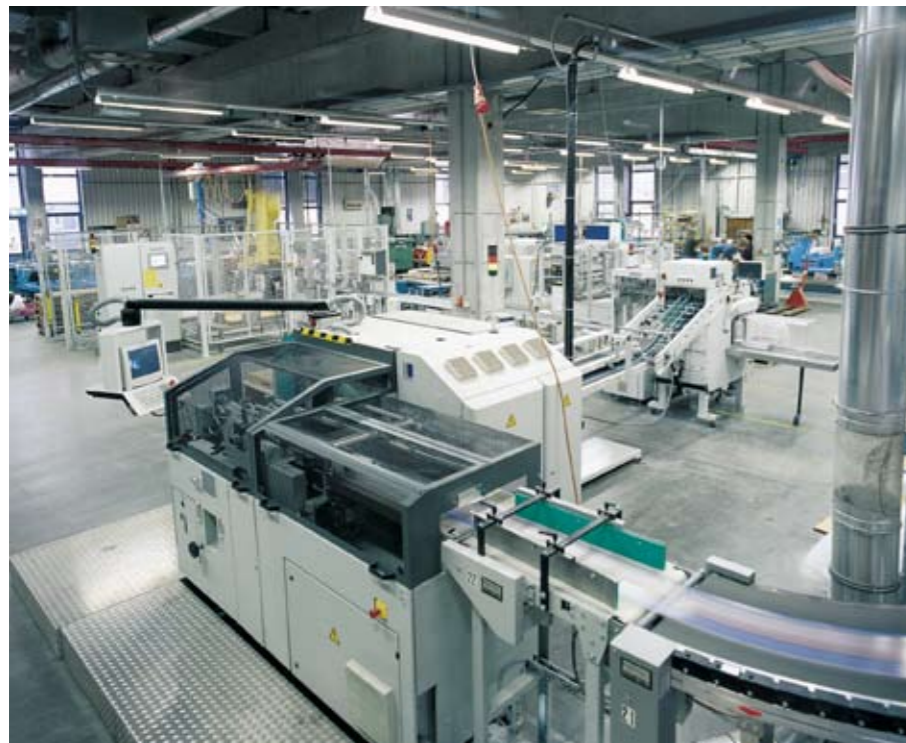
▲ Der RS 33S Buchbinderei-Kreuzleger für dicke Produkte übernimmt die klebegebundenen und geschnittenen Produkte (bis 80 mm Produkthöhe) und bildet sauber kreuzgelegte Stapel. Die hohe Qualität der Pakete wird vor allem durch die „Table-up Option“ des RS 33S erreicht. Sie minimiert die Fallhöhe zwischen Vorstapel- und Drehkorb und ermöglicht die kontrollierte Übernahme der Teillage aus dem Vorstapelkorb in den Drehkorb.
