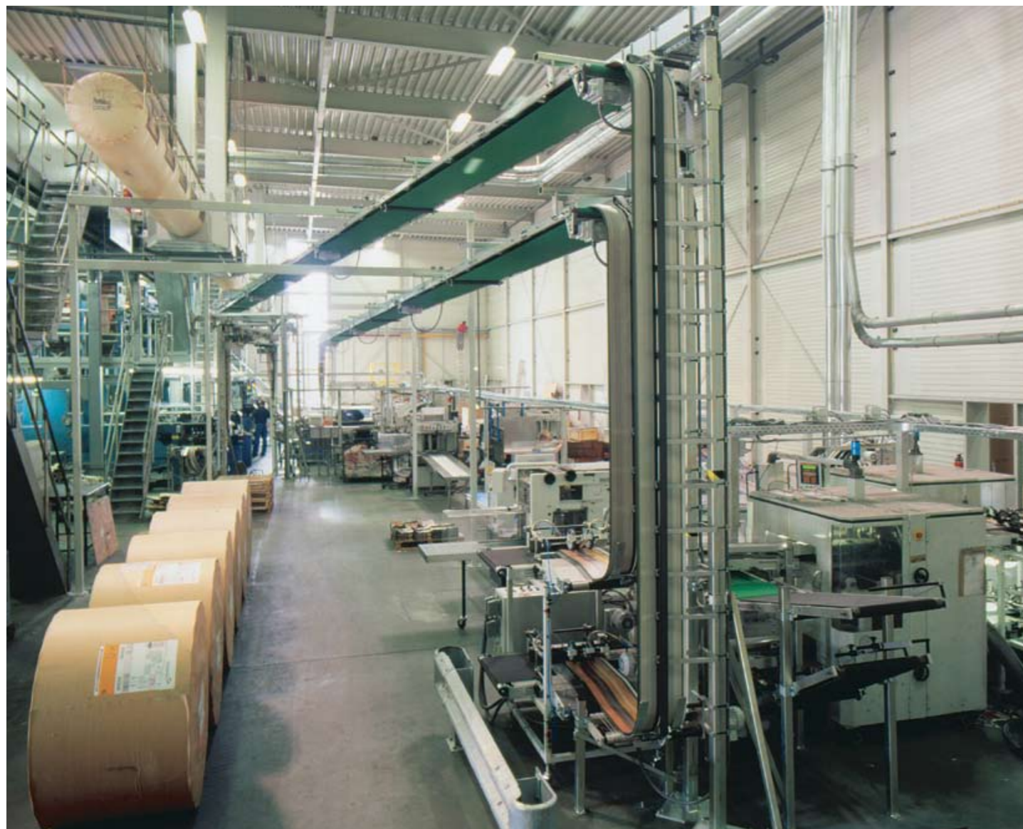
Das RS 2672 Hochfördersystem transportiert die Schuppenströme der vier Falzauslagen für den Dreiseitenbeschnitt zu den Doppelstromschneidern RS 840 oder zu zwei RS 31SL Kreuzlegern.
