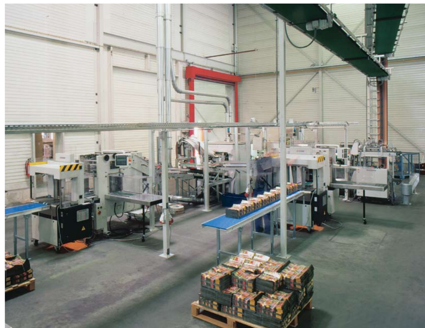
Der Einsatz von Hochfördersystemen, eine kompakte Konfiguration und ein zentral angeordneter Packbereich mit langen Rollenauslagetischen erlauben es, die gesamte Post Press Anlage mit minimalem manuellen Einsatz zu fahren.
