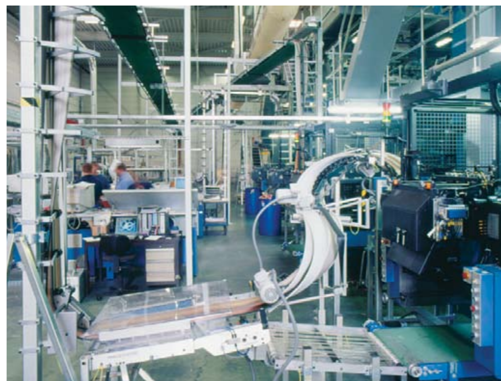
Das RS 2672 Hochfördersystem transportiert die Schuppenströme der vier Falzauslagen für den Dreiseitenbeschnitt zu den Doppelstromschneidern RS 840 oder zu zwei RS 31SL Kreuzlegern.
