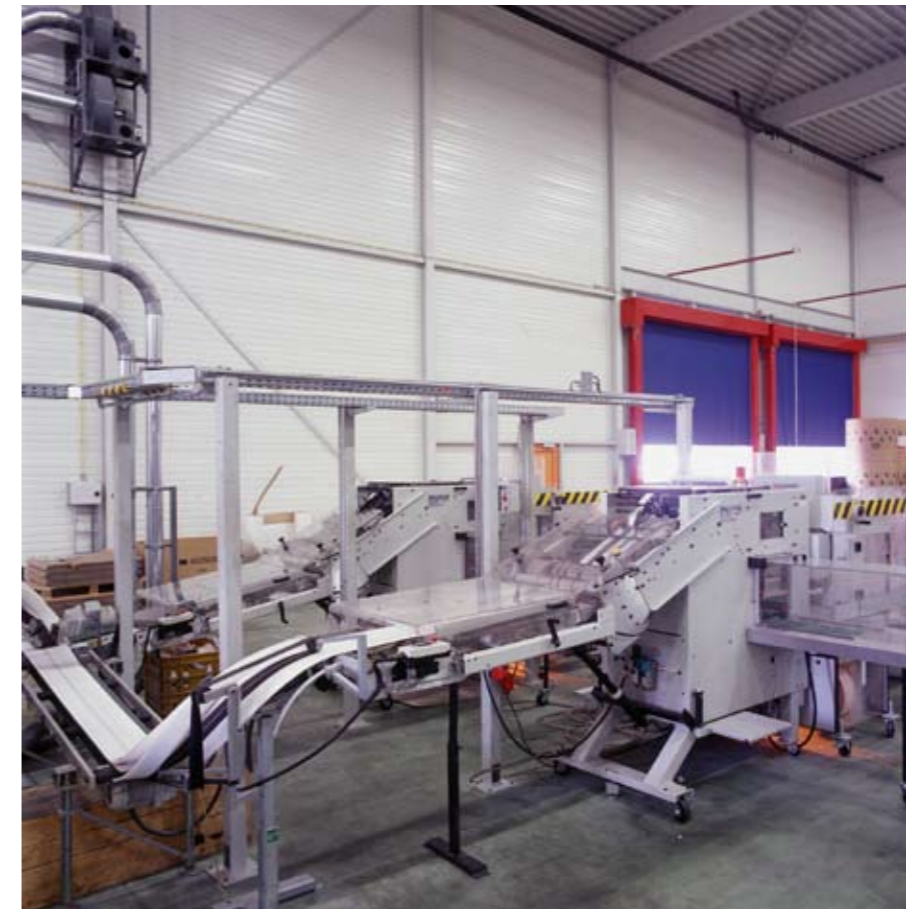
▲ RS 2872 - die preiswerte Hochförderlösung für leichte Produkte: Durch den Einsatz der beiden RS 2872 - Hochförderstrecken von RIMA-SYSTEM haben die Bediener schnell und einfach Zugang zu den Falzausgängen und der Post Press Anlage. Die geringen Investitionskosten des Rs 2872 erlauben seinen Einsatz auch bei geringen Budgets.
