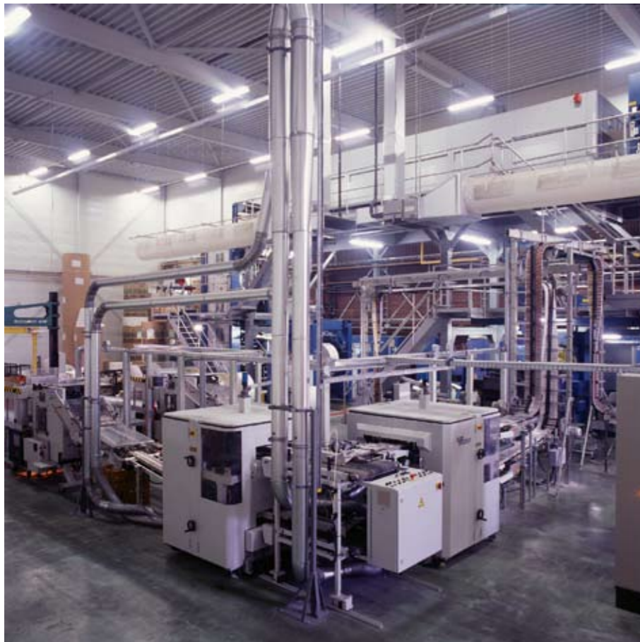
▲ Kompakt und einfach zu bedienen: Gesamtansicht der Post Press Anlage mit Boden- und Hochförderern, Doppelstromschneider RS 4VC 541 FR, den RIMA-SYSTEM RS 31SL Kreuzlegern und den Umreifungsmaschinen Media-S von Signode.
