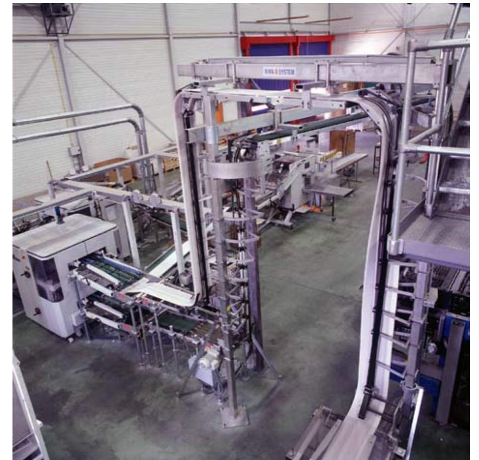
▲ RS 2872 - die preiswerte Hochförderlösung für leichte Produkte: Durch den Einsatz der beiden RS 2872 - Hochförderstrecken von RIMA-SYSTEM haben die Bediener schnell und einfach Zugang zu den Falzausgängen und der Post Press Anlage. Die geringen Investitionskosten des Rs 2872 erlauben seinen Einsatz auch bei geringen Budgets.
