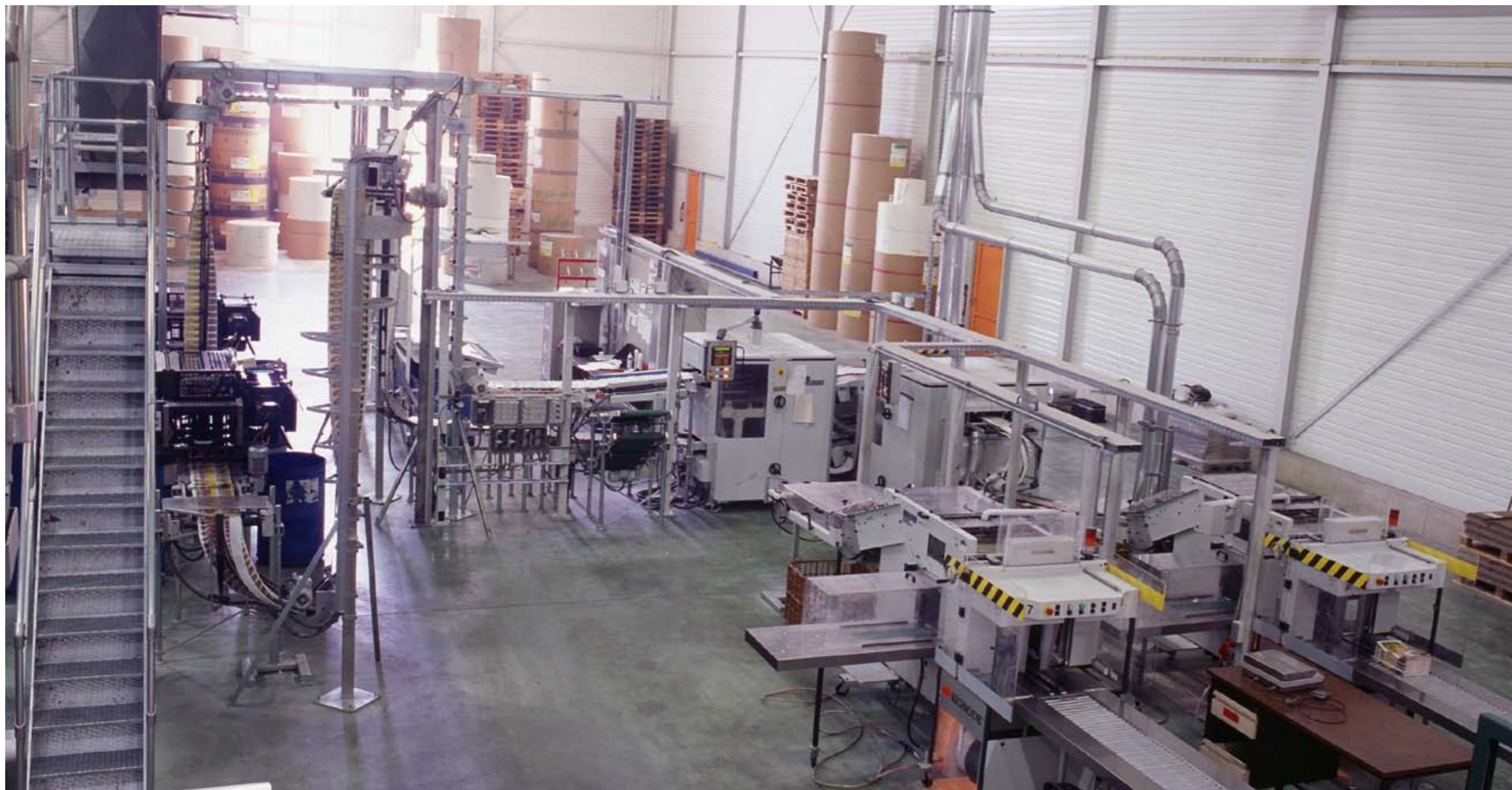
▲ Kompakt und einfach zu bedienen: Gesamtansicht der Post Press Anlage mit Boden- und Hochförderern, Doppelstromschneider RS 4VC 541 FR, den RIMA-SYSTEM RS 31SL Kreuzlegern und den Umreifungsmaschinen Media-S von Signode.
