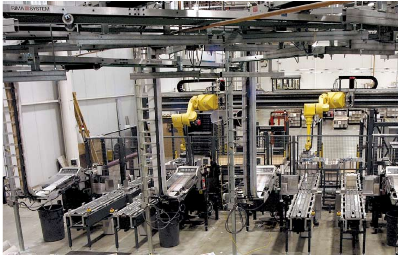
▲ Gesamtansicht des Stapel- und Palettierbereiches mit vier Hochförderlinien, vier RS 50S Vertikal-Staplern, vier Paketförderern mit manueller Abnahme von Musterpaketen und dem RS 500 Doppel-Palettierroboter.
