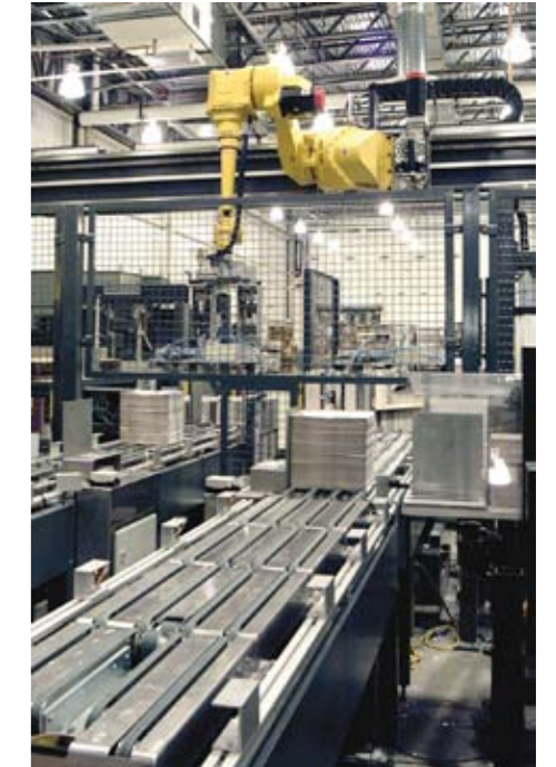
▲ Über die Paketförderer werden die abgepressten, backsteinartigen Pakete vom RS 50S zu den Übergabestationen transportiert. Der „Reverse Modus“ ermöglicht das manuelle Abnehmen von Musterpaketen und die Auslage kann als zusätzliches Stauband genutzt werden.
