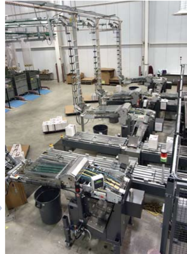
▲ Die Schuppenströme der vier Linien werden hinter dem PFF 2 Falzer mit dem Hilfe von Ecken Rücken voran ausgerichtet und über vier Hochfördersysteme zu den RS 50S Vertikal-Staplern transportiert. Diese Konfiguration garantiert einen schnellen und direkten Zugang zu allen Maschinen.
