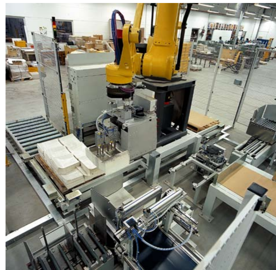
▲ Der RS 400 Multifformat-Palettierer verarbeitet lose Stapel im Formatbereich A4 (Doppelgreifer) und A3 (Multi-Greifer). Der Greiferwechsel erfolgt vollautomatisch in ca. 60 Sekunden. Mit bis zu 800 Paketen pro Stunde palettiert der RS 400 lose Pakete von 2 Rotationen.
