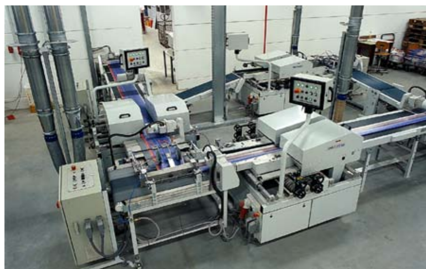
▲ RS 820 Schneider mit optimiertem Einlaufrüttler, Kühlung der Schnittkante und „Zero-gap-Adjustment“ für optimale Schnittqualität. Mit der neuen „Multi-Knife-Technologie“ können die RIMA-SYSTEM Rotationsschneider wahlweise mit Hartmetall- oder Segmentmessern ausgerüstet
