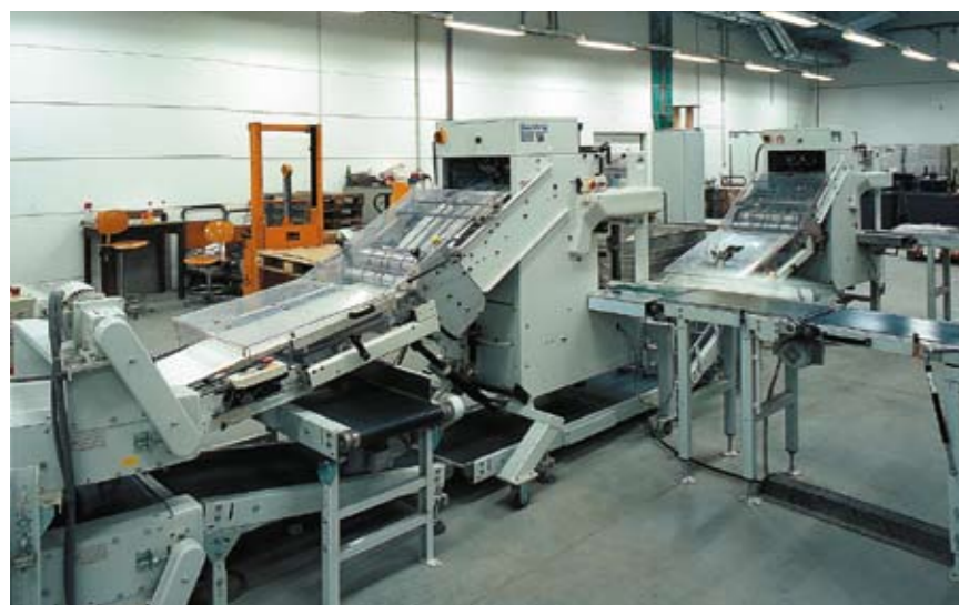
▲ Die beiden RS 25SN Zeitungskreuzleger übernehmen die Schuppenströme von den beiden Schneidelinien. Das Unterfahren des ersten Kreuzlegers ermöglicht die kompakte und leicht zugängliche Aufstellung der beiden Zeitungskreuzleger.
