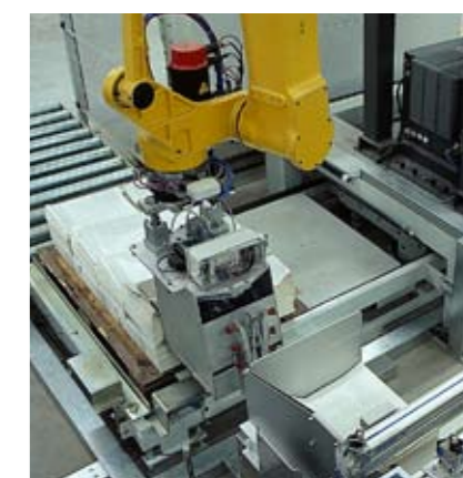
▲ Der RS 400 Multifformat-Palettierer verarbeitet lose Stapel im Formatbereich A4 (Doppelgreifer) und A3 (Multi-Greifer). Der Greiferwechsel erfolgt vollautomatisch in ca. 60 Sekunden. Mit bis zu 800 Paketen pro Stunde palettiert der RS 400 lose Pakete von 2 Rotationen.
