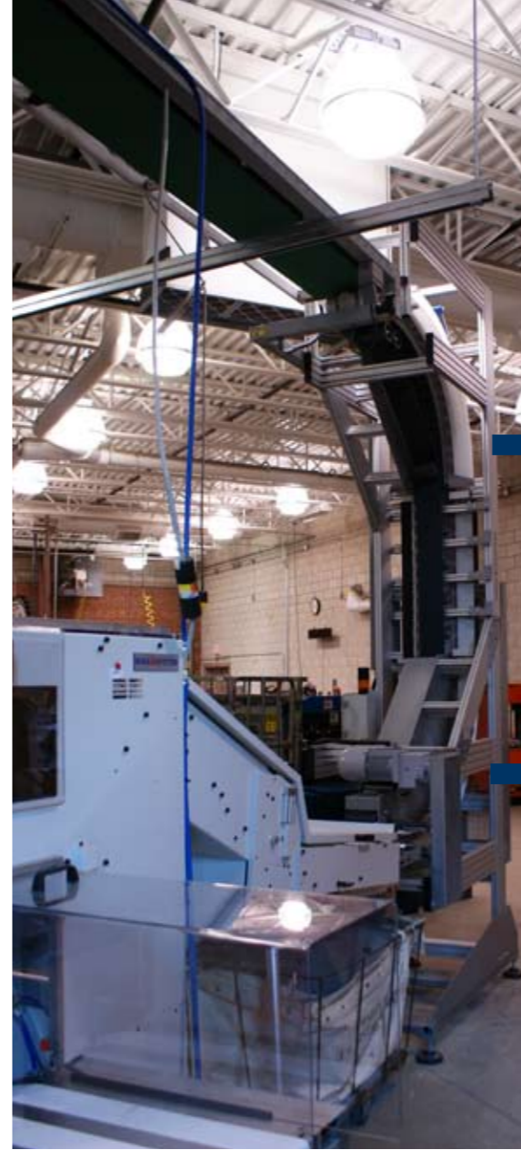
Der negative Schuppenstrom gelangt über Hochförderbänder zum Niederförderturm, der die Produkte C-förmig abwärts führt und den positiven Schuppenstrom an den RS 36 Indexing Kreuzleger für Zeitungen übergibt. Der RS 36 verarbeitet auch seitenstarke Produkte in perfekt abgepresste Pakete. Über ein Servo-Ausstoßersystem mit vollsynchronisierten Auslagebändern werden die Pakete an einen druckluftbetriebenen Auslagetisch übergeben.
