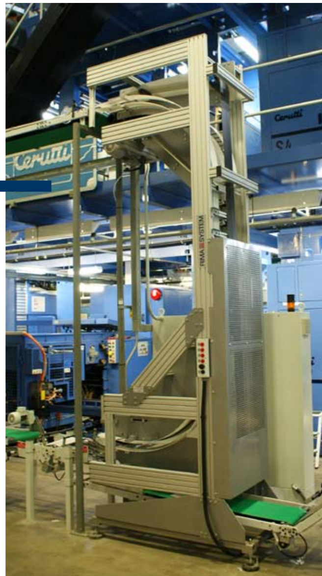
Die speziell für Zeitungsprodukte entwickelten C-förmigen Hoch- und Niederfördertürme ermöglichen den platzsparenden und sicheren Transport der Produkte. Zwischen besonders robusten Förderriemen wird der Schuppenstrom um 90° ohne Wendung aufwärts geführt und negativ weitergeleitet.
