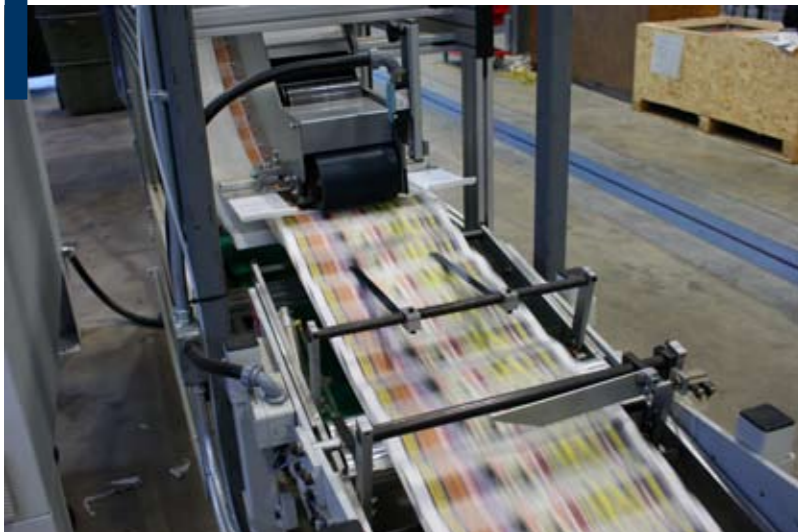
Die speziell für Zeitungsprodukte entwickelten C-förmigen Hoch- und Niederfördertürme ermöglichen den platzsparenden und sicheren Transport der Produkte. Zwischen besonders robusten Förderriemen wird der Schuppenstrom um 90° ohne Wendung aufwärts geführt und negativ weitergeleitet.
