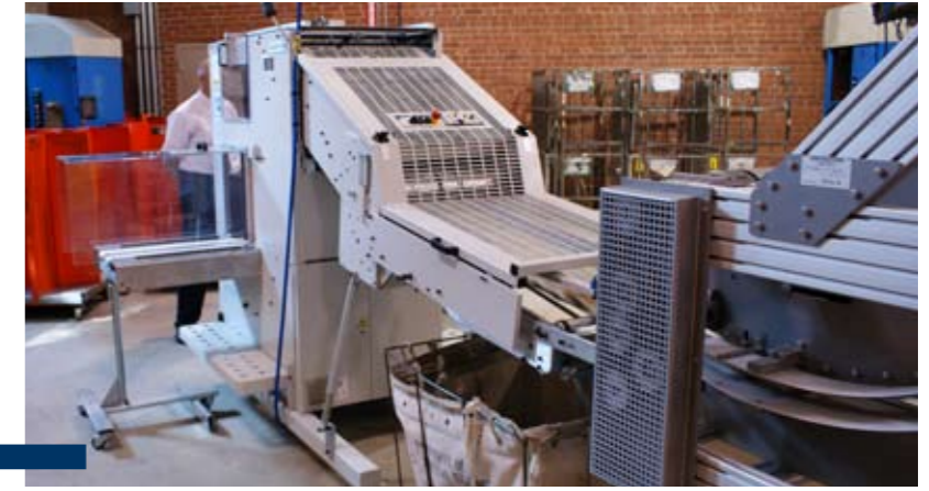
Der negative Schuppenstrom gelangt über Hochförderbänder zum Niederförderturm, der die Produkte C-förmig abwärts führt und den positiven Schuppenstrom an den RS 36 Indexing Kreuzleger für Zeitungen übergibt. Der RS 36 verarbeitet auch seitenstarke Produkte in perfekt abgepresste Pakete. Über ein Servo-Ausstoßersystem mit vollsynchronisierten Auslagebändern werden die Pakete an einen druckluftbetriebenen Auslagetisch übergeben.
