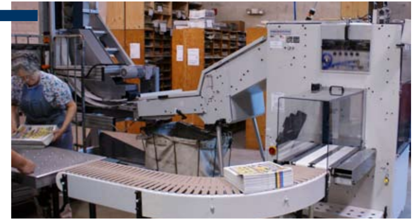
Der negative Schuppenstrom gelangt über Hochförderbänder zum Niederförderturm, der die Produkte C-förmig abwärts führt und den positiven Schuppenstrom an den RS 36 Indexing Kreuzleger für Zeitungen übergibt. Der RS 36 verarbeitet auch seitenstarke Produkte in perfekt abgepresste Pakete. Über ein Servo-Ausstoßersystem mit vollsynchronisierten Auslagebändern werden die Pakete an einen druckluftbetriebenen Auslagetisch übergeben.
