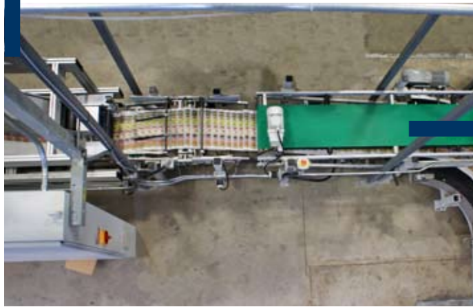
Die Schuppenströme der A3 und A4 Falzauslagen werden über Bodenfördersysteme zu der zentralen Makulaturaussteuerweiche geführt, wo Anfahr-, Wasch- und Klebemakulatur ausgesteuert wird. Gutkopien laufen von dort in den für Zeitungen entwickelten Heavy-Duty Hochförderturm.
